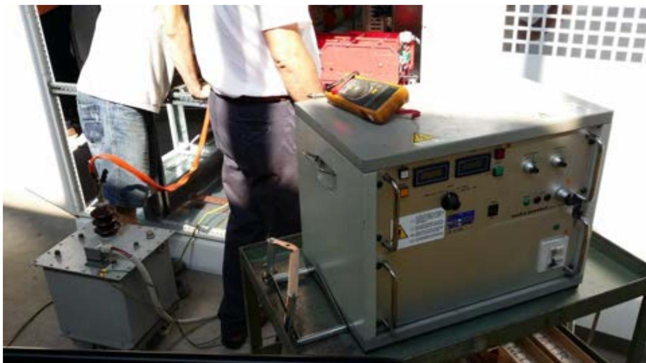
Figura 14. Collegamento del trasformatore a 20 kV durante le prove di isolamento.
