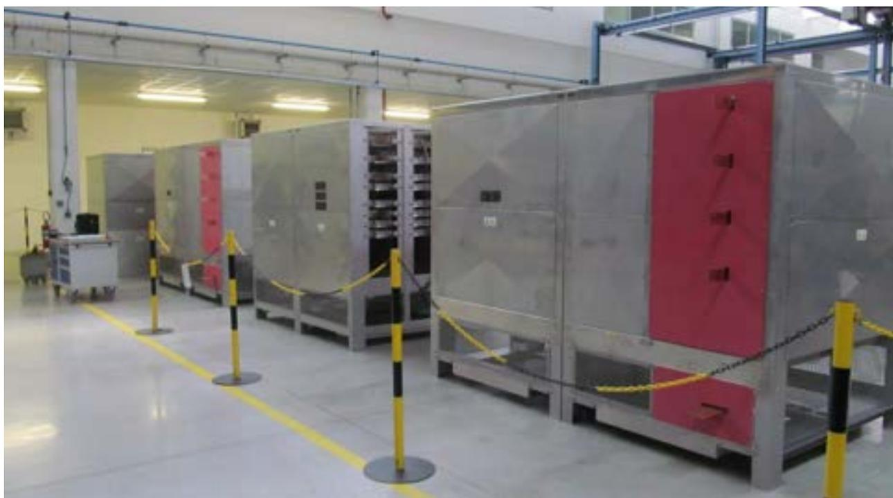
Figura 9. Cubicle dei resistori di breakdown pronti per i test di isolamento.
