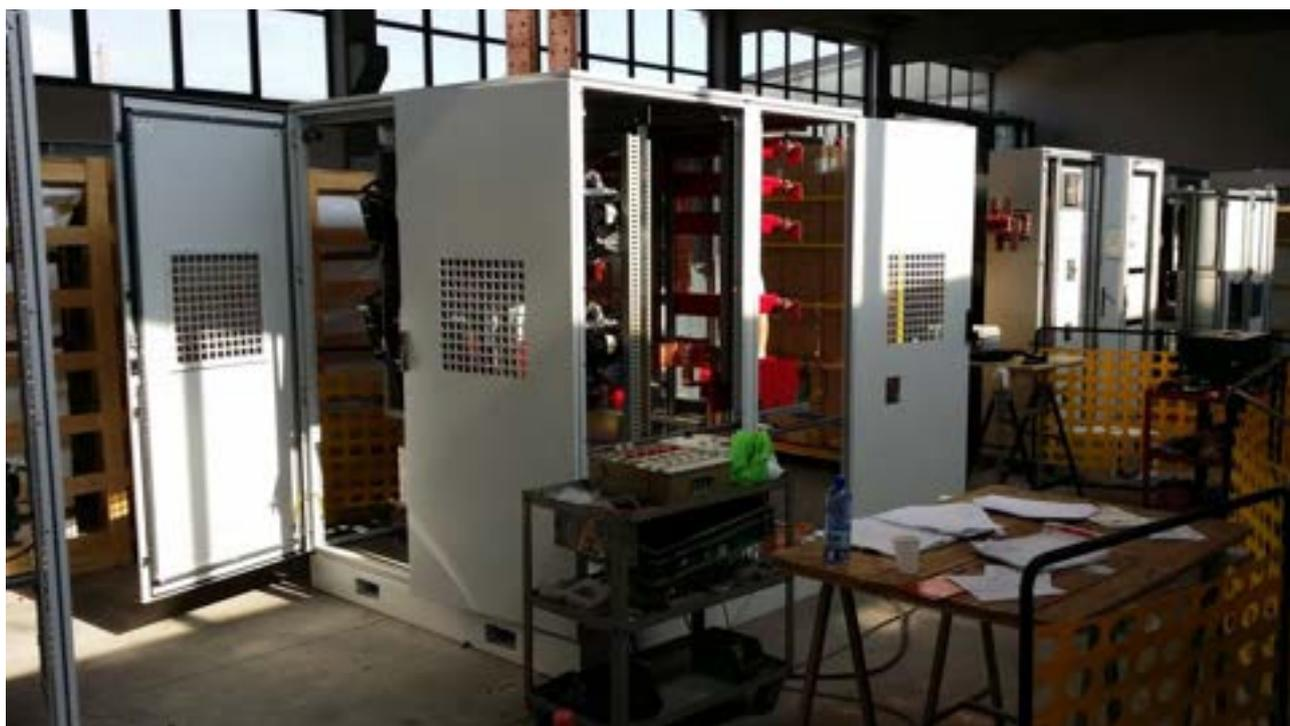
Figura 13. Cubicle dei BPS delle tre SNU di serie durante le prove di tenuta in tensione.
