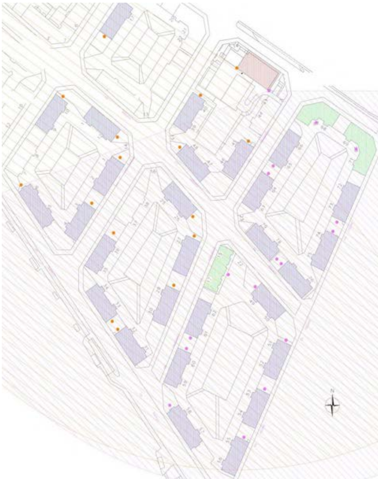
Figura 48 - Dislocazione antenne e copertura radio
