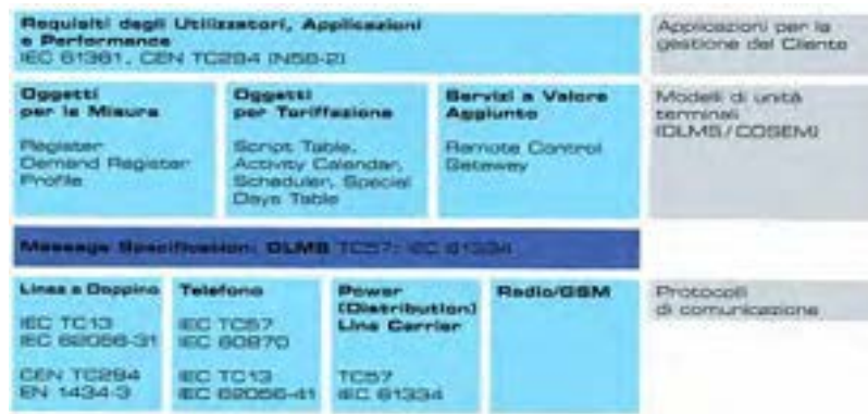
Figura 5: Struttura di un dispositivo DLMS compliant
