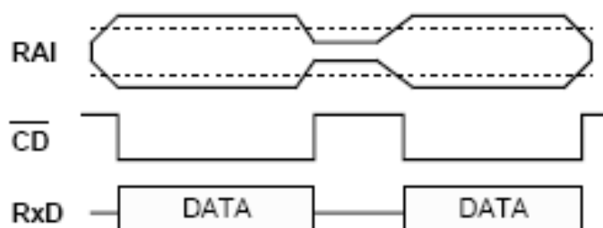
Figura 25 Andamento di RXD in funzione di RAI
