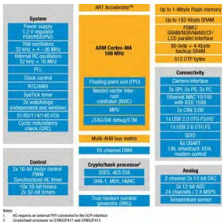
Figura 8 Schema a blocchi del microcontrollore ARM Cortex M4
