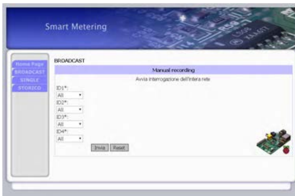
Figura 15 Interfaccia web per l'interrogazione Broadcast
