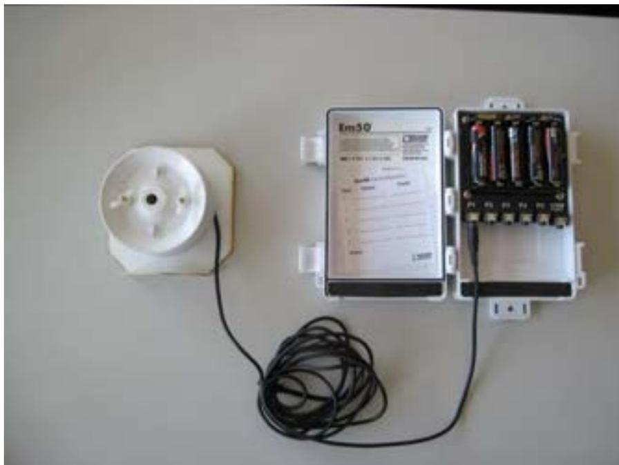
Figura 1: Termo-Igrometro (sinistra) e scheda di acquisizione.
