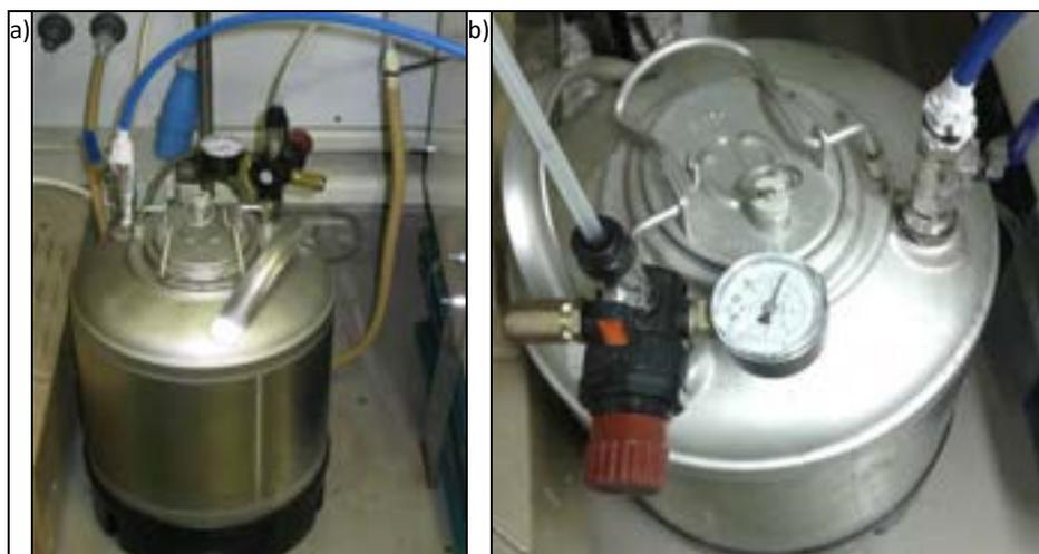
Figura 6. a) Serbatoio utilizzato al Politecnico di Milano per la nebulizzazione; b) dettaglio del serbatoio utilizzato e valvole. Il serbatoio deve essere dotato di valvole di sicurezza e di un manometro.
