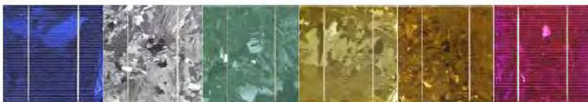
Figura 54 - Celle in silicio policristallino. La prima a sinistra presenta il colore tipico del trattamento antiriflettente che permette di ottenere la migliore efficienza. La seconda rappresenta il colore grigio senza trattamento del silicio policristallino. Gli altri colori sono ottenuti con diversi film antiriflettenti [46].
