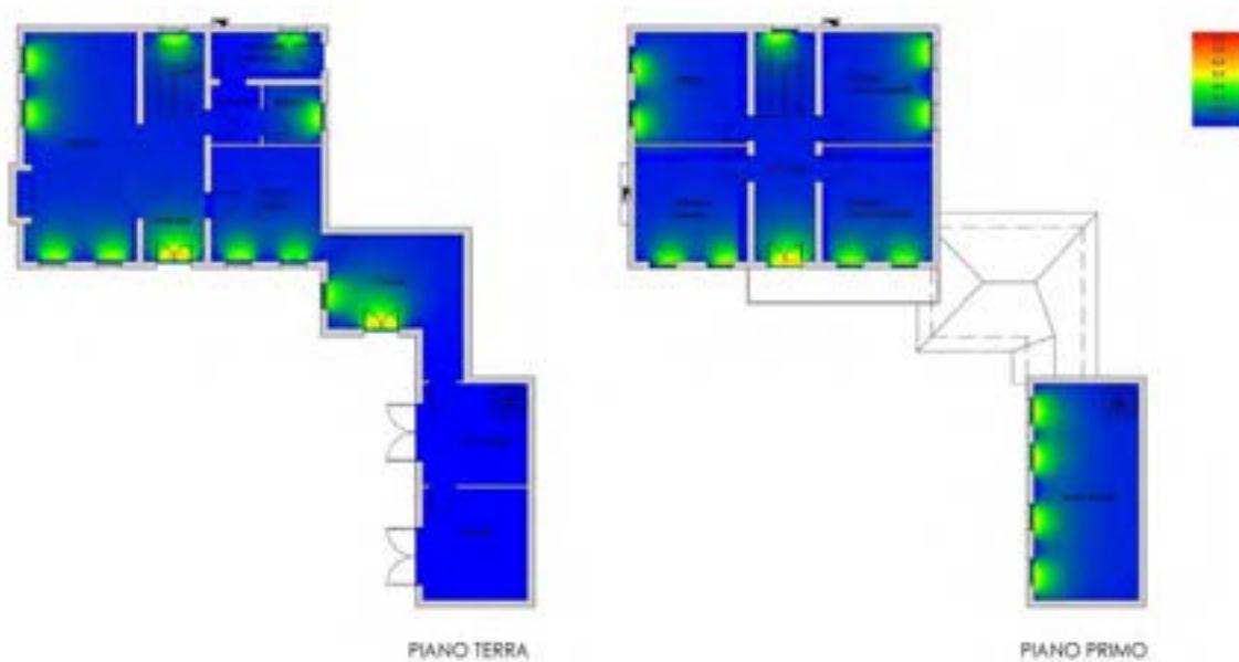
Figura 38 - Fattore medio di luce diurna con l'inserimento del sistema BIPV
