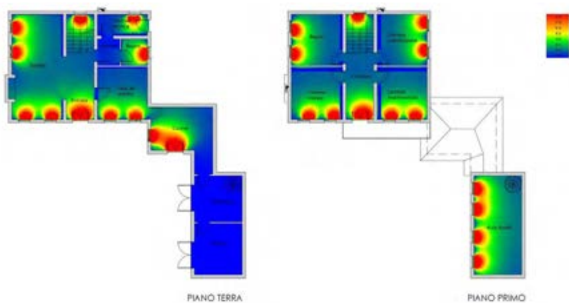
Figura 37 - Fattore medio di luce diurna prima dell'inserimento del sistema BIPV
