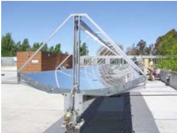
Figura 2.5. Coventry [17]: prototipo di concentratore parabolico fotovoltaico-termico con inseguimento su un asse.
