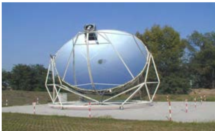
Figura 7. Impianto sperimentale Dish/Stirling EuroDish da 10 kWe.
