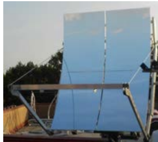
Figura 2.6. Del Col et al. [21]: prototipo di concentratore parabolico fotovoltaico-termico con inseguimento su due assi.
