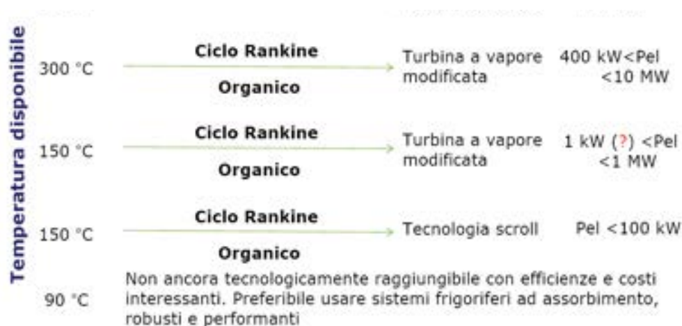
Figura 5. Tecnologie impiantistiche applicabili in funzione della temperatura disponibile e della produzione di energia elettrica.
