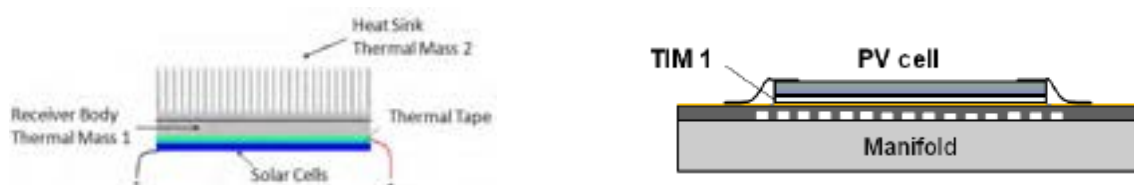
Figura 2.3. Esempi di dispositivi per il controllo termico delle celle fotovoltaiche: raffreddamento passivo (a sinistra) [11] e raffreddamento attivo [12].
