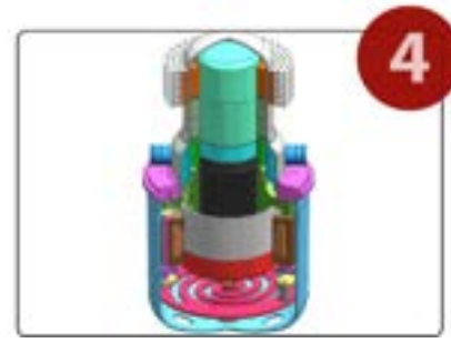
Figura 10. Fasi di funzionamento del motore Stirling "free piston" (Fonte: Microgen)
