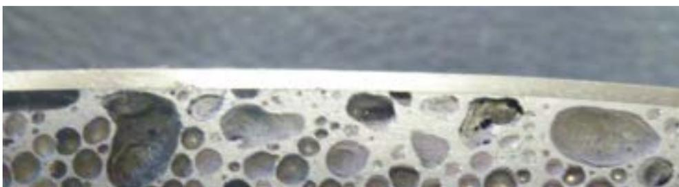
**Figura 27. Particolare del pannello ottenuto con schiumatura del precursore composito nel contenitore di rame.**
