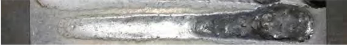
**Figura 18: effetti transitori dovuti alla bassa densità di energia del processo di saldatura TIG su AFS**
