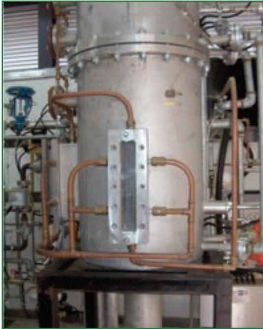
Particolare di una delle quattro finestre ottiche in quarzo per diagnostiche ottiche o laser
