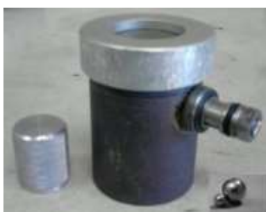
Figura 2: giara per macinazione di polveri mediante lo SPEX 8000.
