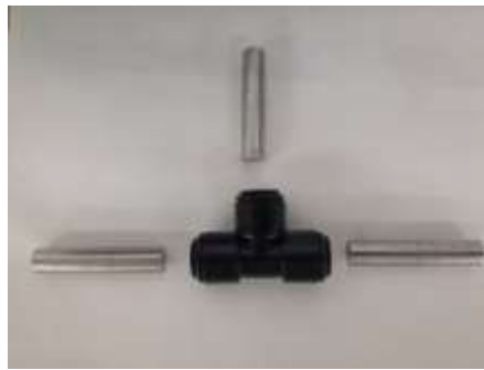
Fig.27. Cella utilizzata per le prove di conducibilità di sospensioni con diverse formulazioni. I pistoni hanno diametro \varphi = 1 cm, area della sezione A = 0,785 cm 2 e sono bloccati all'interno a distanza L = 1 cm. La cella è di 5,05 \times 3,3 cm.
