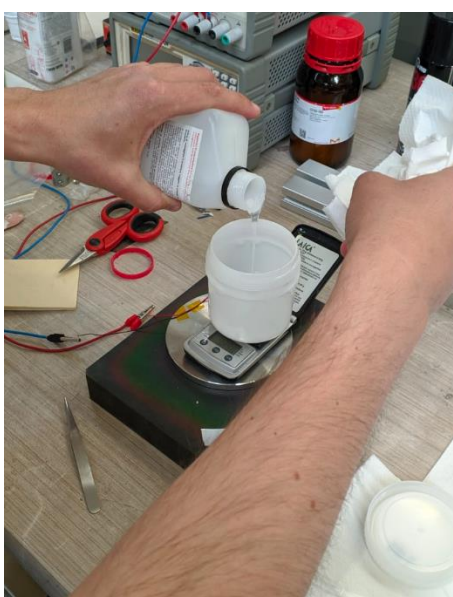
Figura 14: Riempimento del container speciale del mixer con silicone e nanoparticelle
