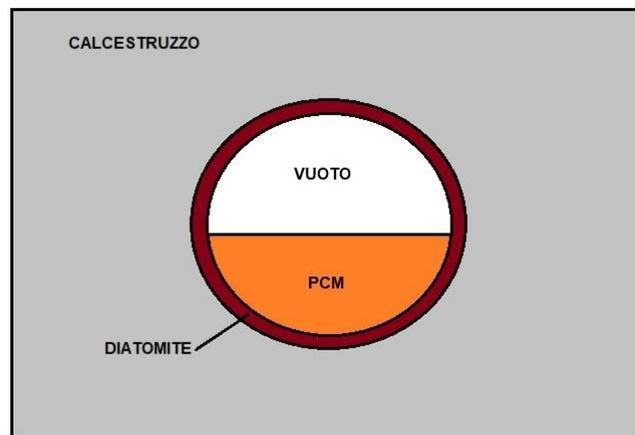
**Figura 2-16** Modello elementare di calcestruzzo/SS-PCM
