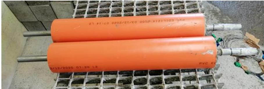
**Figura 2-14** Provini con tubo immerso estratti dal supporto dopo 48 ore ed in fase di stagionatura per 28 giorni
