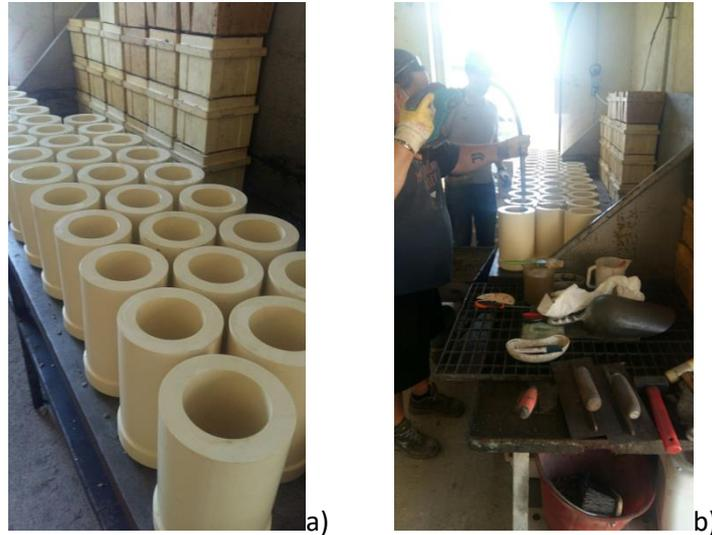
**Figura 2-7 Stampi utilizzati per la preparazione dei provini (a) e fase di getto e vibroformatura (b)**
