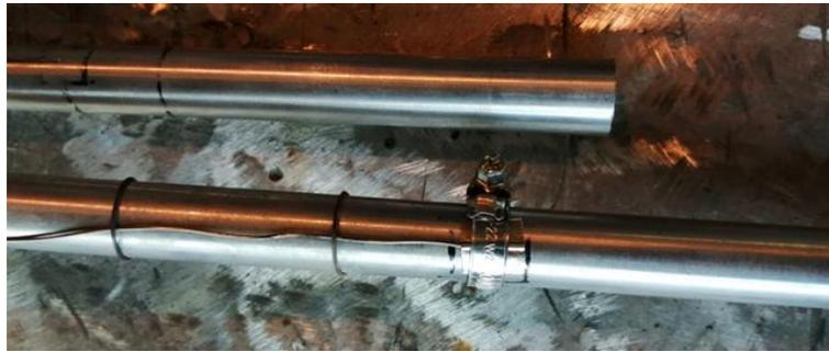
**Figura 2-12** Bloccaggio di una piastrina con termocoppia su un tubo attraverso una fascetta metallica
