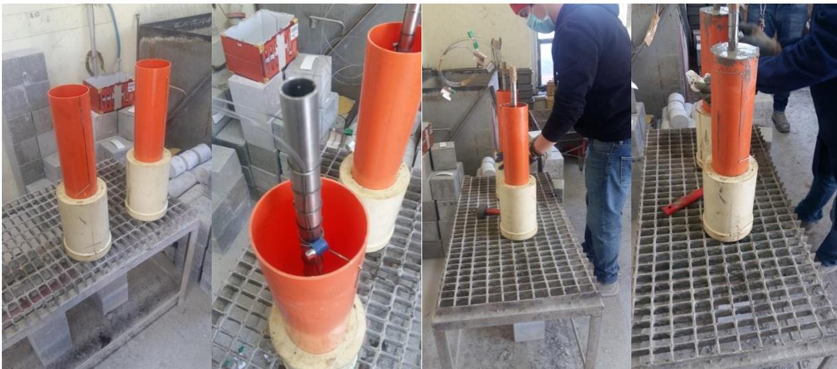
**Figura 2-13** Fasi del getto di calcestruzzo per provini con tubo. Da sinistra: preparazione dello stampo, posizionamento del tubo con termocoppie, riempimento e vibratura, completamento del getto.
