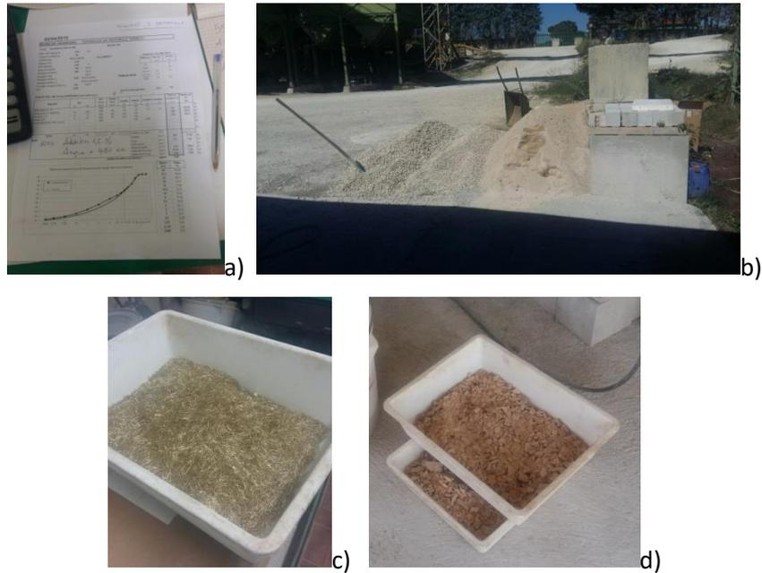
**Figura 2-5 Formulazione del mix-design (a) e principali materiali utilizzati: aggregati (b); fibre metalliche (c) e mEPCM (d)**
