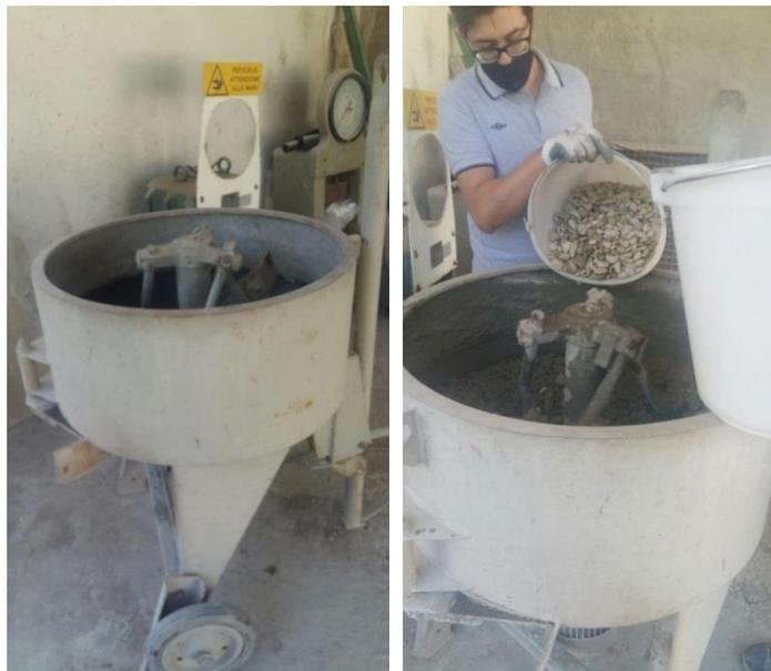
**Figura 2-6 Miscelazione del calcestruzzo ed eventuale mPCM in un contenitore remix a pala quadrata**
