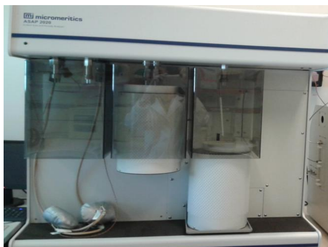
Figura 2. Strumento per analisi BET e BJH della Micromeritics modello ASAP 2020.
