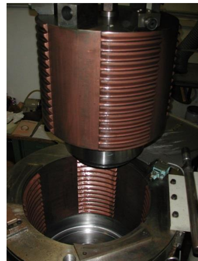
Figura 8. Schematizzazione della pressatura isostatica a freddo [45] e particolare dell'apertura della pressa isostatica a freddo disponibile presso i Laboratori ENEA di Faenza
