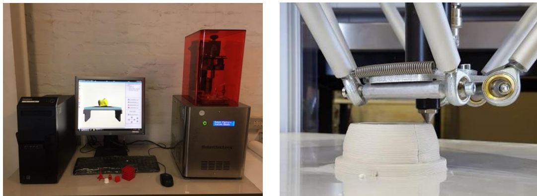
Figura 10. Stampanti 3D presso i laboratori ENEA di Faenza: tecnologia DLP (variante della stereolitografia) e tecnologia LDM (variante del fused deposition modeling)
