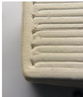
*Variabili principali:* Altezza dello strato 0,7 mm (uguale rispetto a Prova 1); Riempimento [0°;90°] (diverso rispetto a Prova 1); una linea di perimetro (diverso rispetto a Prova 1); stampa del riempimento prima del perimetro (diverso rispetto a Prova 4). Slicer: Cura Ultimaker versione 4.3.
