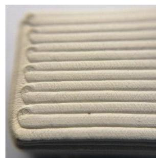
*Variabili principali:* Altezza dello strato 0,7 mm (uguale rispetto a Prova 1); Riempimento [0°;90°] (diverso rispetto a Prova 1); una linea di perimetro (diverso rispetto a Prova 1); stampa del perimetro prima del riempimento. Slicer: Cura Ultimaker versione 4.3.
