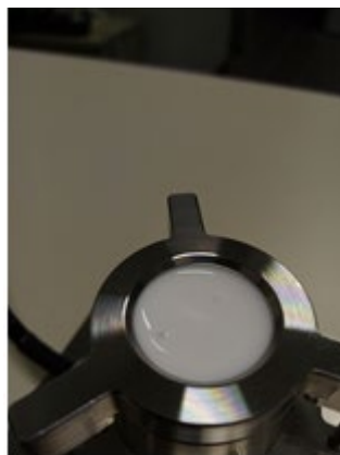
Figura 27. Sensore TCi C-THERM con PCM micro-incapsulato.
