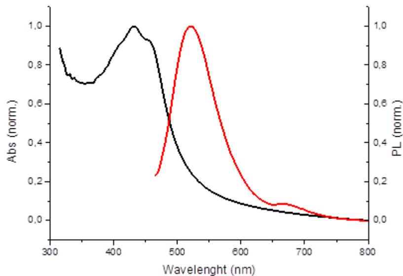
Figura 35. Spettri di assorbimento (traccia nera) e di emissione (traccia rossa) del complesso 5a.
