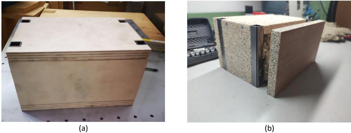
**Fig. 2. Prototipo di blocco accumulatore con struttura contenitiva e tubolari metallici a sezione quadrata per assemblaggio. a) Prototipo 1: struttura contenitiva in legno compensato, b) Prototipo 2: struttura contenitiva in fibre di canapa.**
