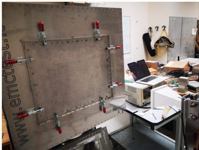
Fig. 16. Apertura (finestra) sulla parete frontale della cella schermata chiusa con flangia di acciaio per la misura della dinamica con antenne horn in polarizzazione verticale.
