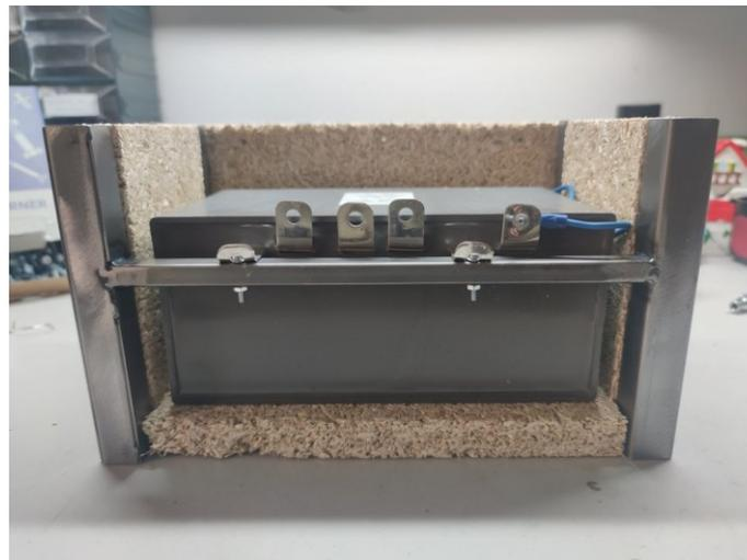
**Fig. 5. Prototipo 2 della tamponatura con contenitore in fibra di canapa non completo: particolare dell'accumulatore elettrico all'interno della struttura contenitiva e dei tubolari metallici per assemblaggio.**
