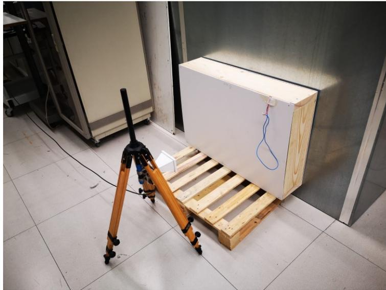
**Fig. 37. Misura della SE della parete modulare con antenne horn in polarizzazione verticale.**
