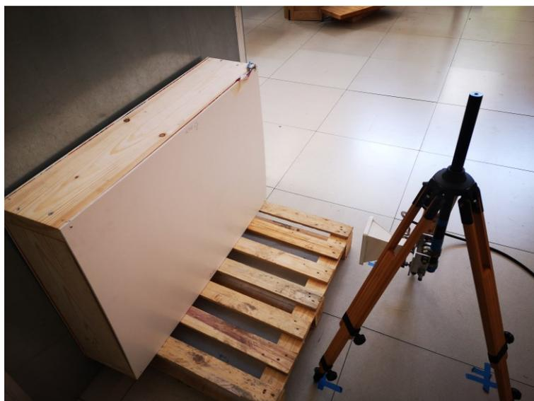
**Fig. 36. Misura della SE della parete modulare con antenne horn in polarizzazione orizzontale.**
