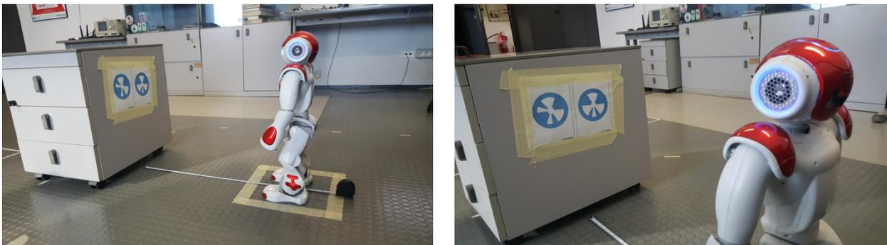
**Figura 27– Setup sperimentale. I marker sono posti a 0.7 m dal centro delle due video camere di bordo.**
