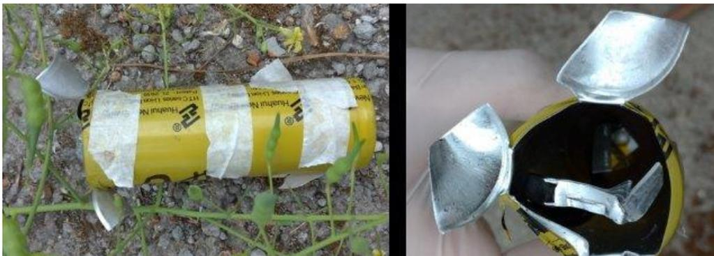
Figura 17 Sovraccarica 1C, Involucro esterno della cella espulso al termine della Fase 1 della sovraccarica
