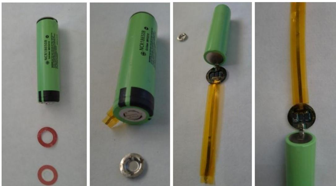
Figura 50 Rimozione del PCB dalla cella protetta
