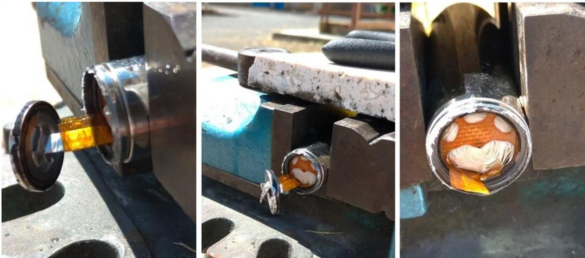
**Figura 52** Rimozione del tappo in corrispondenza del catodo
