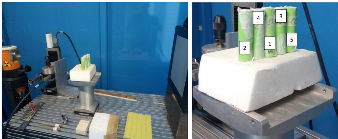
**Figura 42 Celle Panasonic sottoposte a controllo radiografico**
