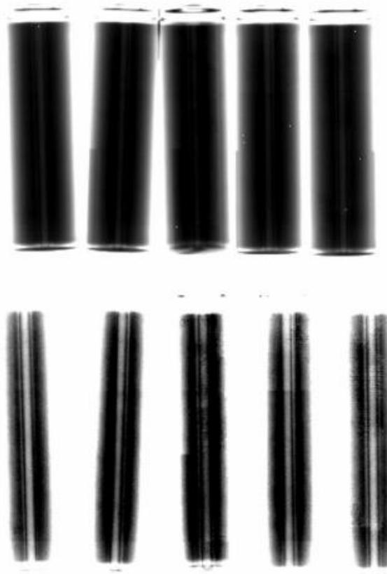
Figura 43 Risultati dell'analisi radiologica delle celle Panasonic
