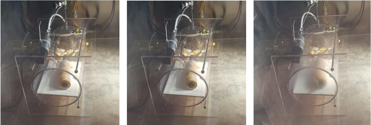
**Figura 37 Venting della cella sovraccaricata: cella integra, apertura del fondo, rilascio del gas.**
