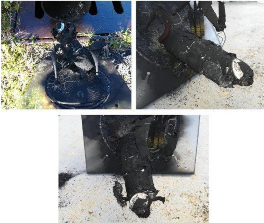
**Figura 41** Residuo della cella dopo il thermal runaway
