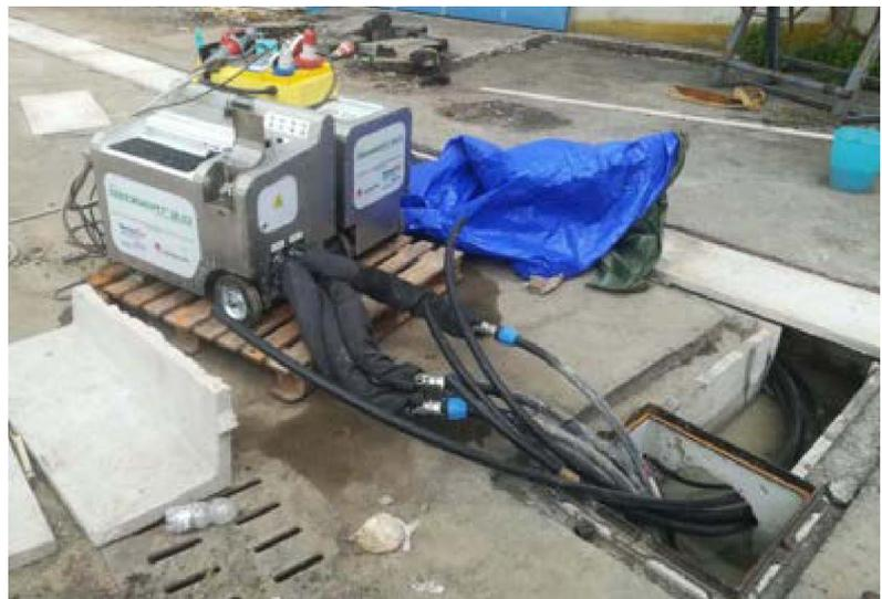
Figura 27. Apparecchiatura strumento GEOfert 2.0 collegata alle sonde geotermiche del pozzo 1 e caratteristiche delle sonde
