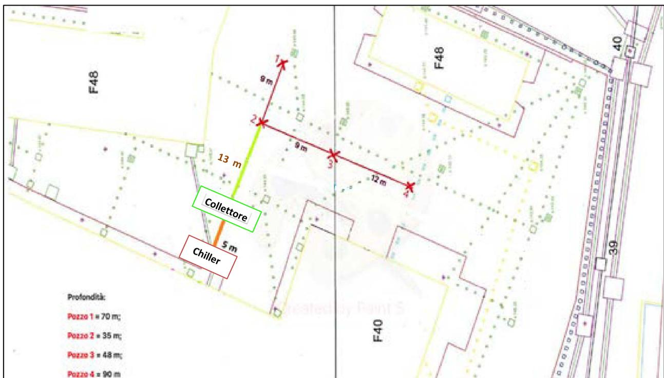
Figura 42. Ubicazione pozzi geotermici e relative distanze
