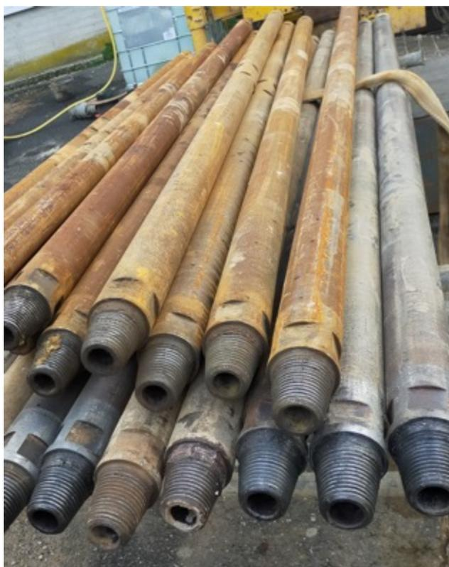
Figura 7. Aste di perforazione
