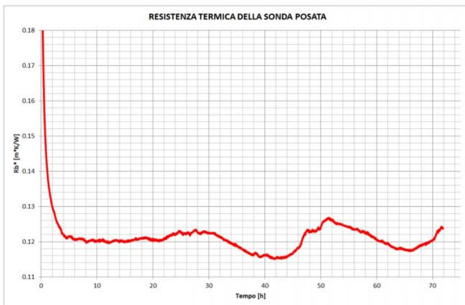
Figura 34. Andamento della resistenza termica della sonda pozzo 1
