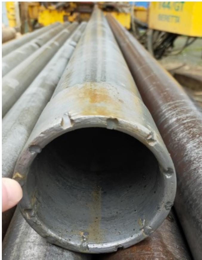
Figura 8. Carotiere per il prelievo del materiale
