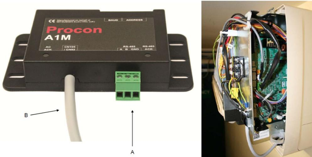
**Figura 69- Immagine e dettaglio costruttivo della scheda di comunicazione installata**
