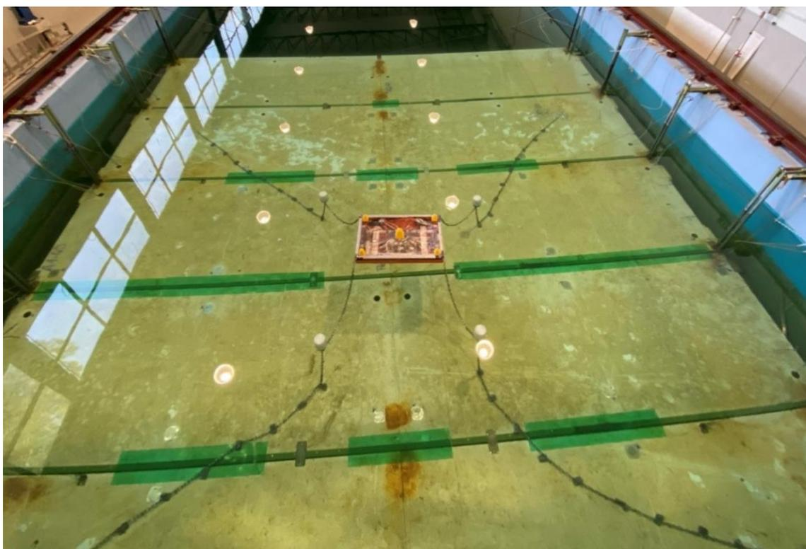
FIGURA 2.14. CONFIGURAZIONE ORMEGGIO A 0° IN VASCA NAVALE
