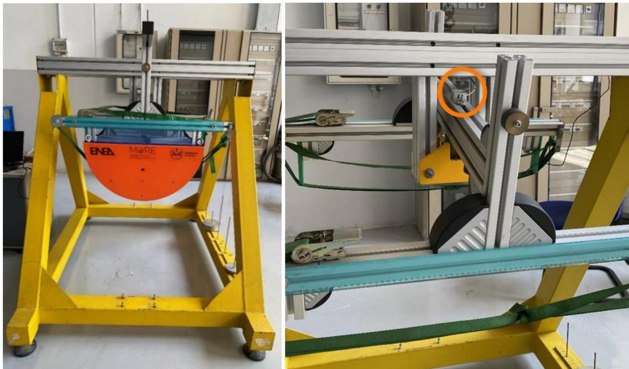
FIGURA 2.10. BILANCIA INERZIALE CON PROTOTIPO E POSIZIONAMENTO ACCELEROMETRO.
