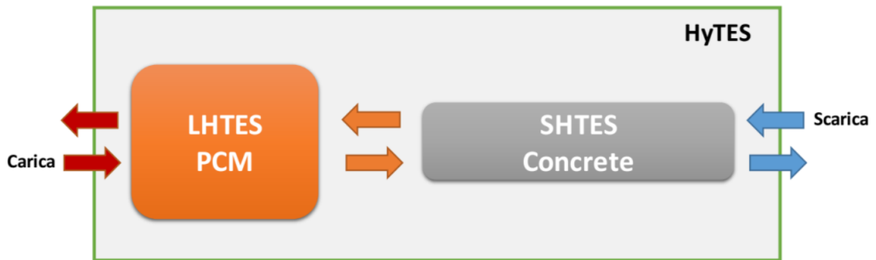
Figura 3: Schematizzazione del sistema di accumulo termico ibrido sensibile/latente.
