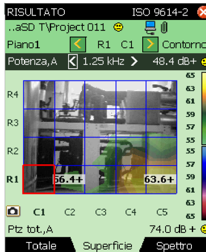
Figura 5 - livello massimo di potenza per la frequenza di 1,25 kHz
