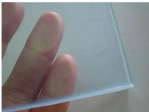
Figura 13: Rivestimento polisilsesquiossanico depositato per stampa drawdown
