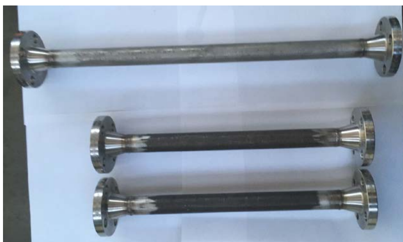
Figura 4: Tronchetti porta provini da inserire nel circuito MoSE
