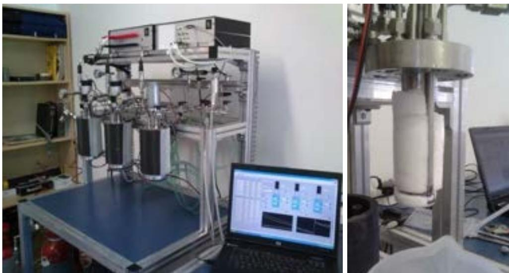
*Apparato RDPower ed esempio di formazione idrato della miscela CH<sub>4</sub>/CO<sub>2</sub>*
