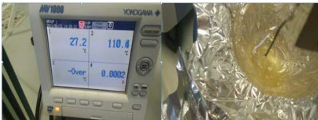
**Figura 13. Descrizione prova visuale per la determinazione del punto di inizio solidificazione della miscela  $\text{NaNO}_3/\text{KNO}_3/\text{Ca}(\text{NO}_3)_2$  16/48/36 (%p). La temperatura rilevata nel terzo canale del registratore di temperature a sinistra (Yokogawa) corrisponde al bloccaggio dell'ancoretta magnetica, dovuto a formazione di solido, rilevato nel pallone di Pirex a destra nella figura**
