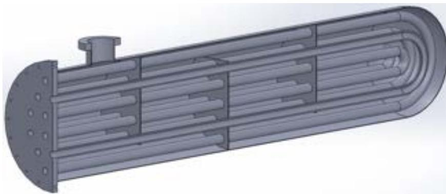
Fig. 38 – Sezione longitudinale dello scambiatore
