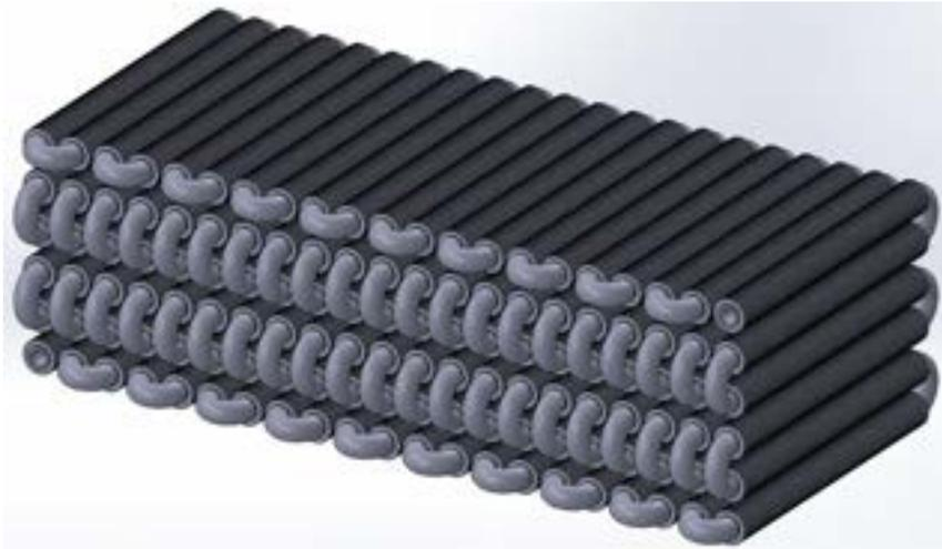
Fig. 22 – Dimensionamento definitivo scambiatore fumi/sali-fusi (modello solido 3-D)
