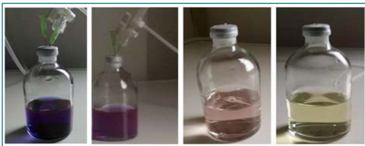
Fig. 4. Fasi dell'ottenimento delle condizioni di anaerobiosi in serum bottles, tramite flussaggio con CO 2 del terreno modificato riducendo la concentrazione di carbonato di sodio
