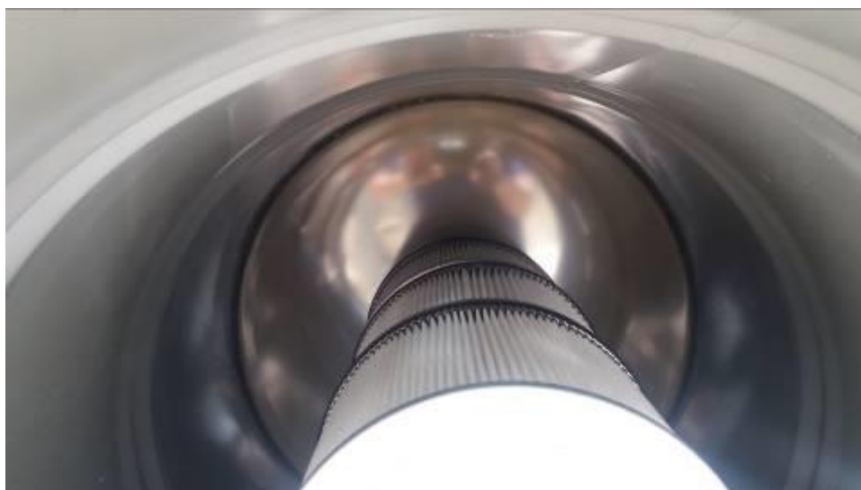
Figura 9. Filtro per MCI, sezione interna
