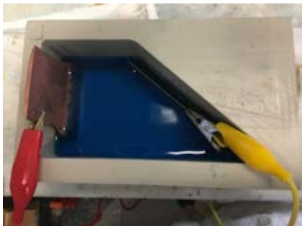
Figura 4: Cella di Hull per la caratterizzazione di bagni elettrolitici di rame) con anodo di Cu (contatto rosso) e catodo di ottone (contatto giallo).
