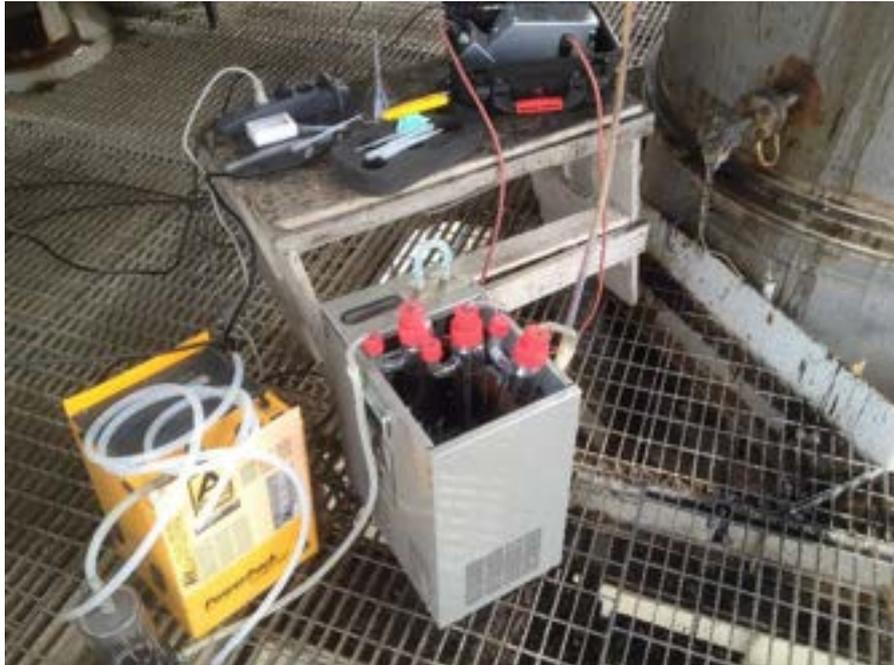
**Figura 26. Sistema di campionamento per la separazione di polveri e TAR costituito da sonda di prelievo riscaldata, batteria di condensatori e misuratore volumetrico di portata**
