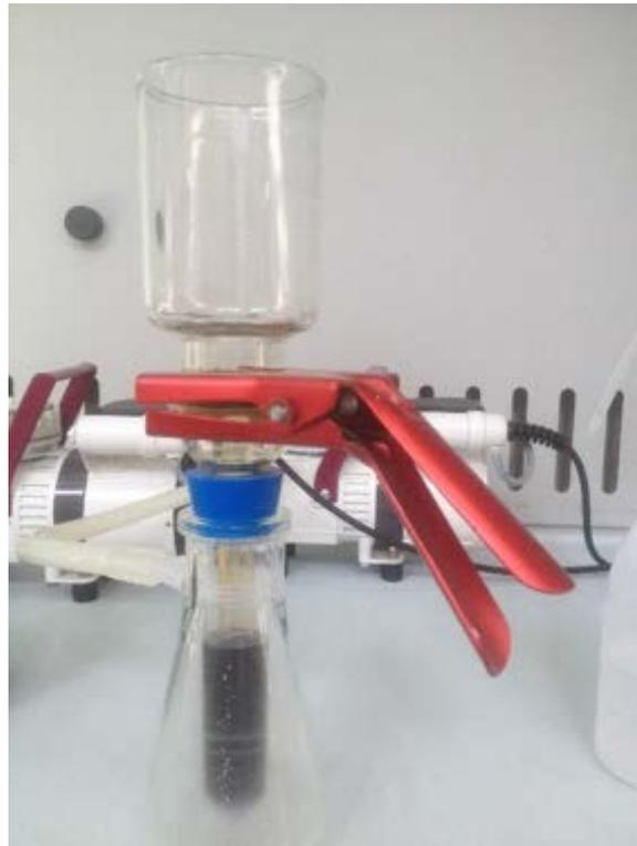
**Figura 27. Sistema di filtrazione del campione separato nei condensatori: polveri e TAR vengono separati sul filtro in acetato di cellulosa, nella beuta si raccoglie il filtrato**
