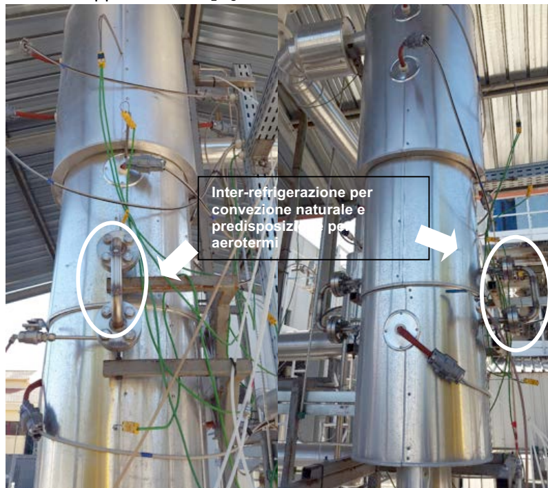
Figure 11 Reattore catalitico (particolare interrefrigerazione)
