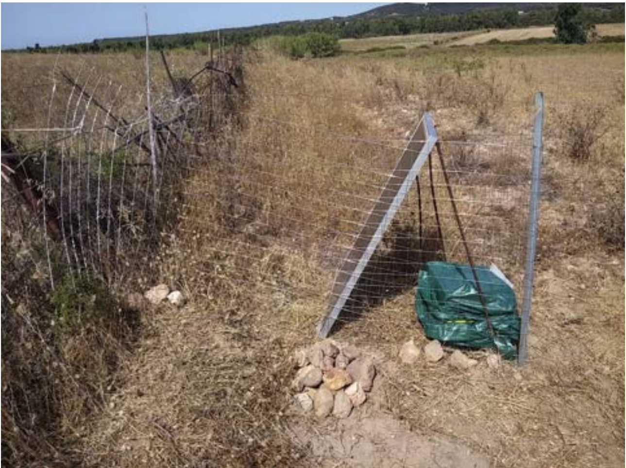
Figura 3.4 – Vista della stazione sismica SU22. La recinzione serve per proteggere la strumentazione dal bestiame. Il cumulo di sassi protegge il sensore dagli animali e dal vento.
