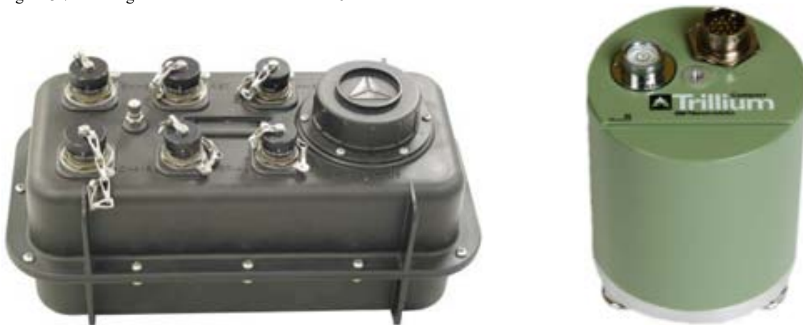
Figura 3.8 – Acquisitore/digitalizzatore 24 bit di tipo Reftek-130_1 (a sinistra) e velocimetro a larga banda di tipo Trillium compact 120 s (a destra). Le immagini dei due oggetti non sono in scala tra loro.
