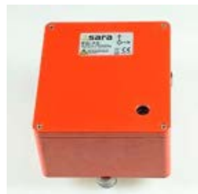
Figura 3.3 – Acquisitore/digitalizzatore 24 bit di tipo Reftek-130_1 (a sinistra) e velocimetro a medio periodo di tipo Sara SSXX 0.2 Hz (a destra). Le immagini dei due oggetti non sono in scala tra loro.
