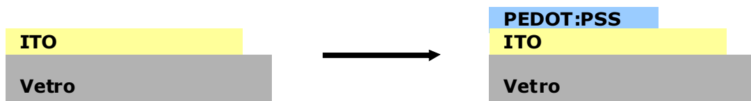
Figura 3: Deposizione dello strato di PEDOT:PSS
