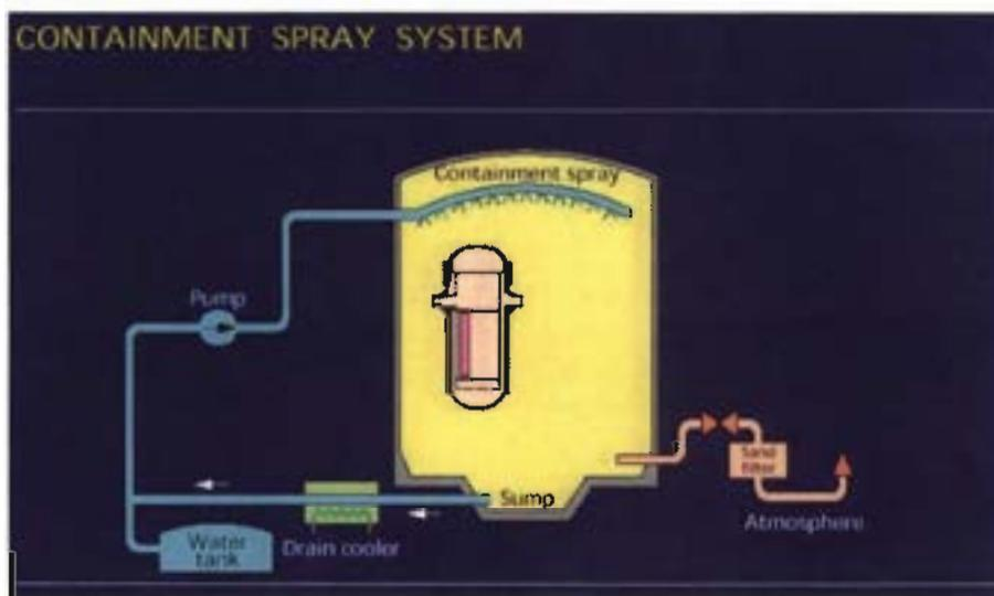
Fig. 1.15 – Sistema di spray nel contenimento.
