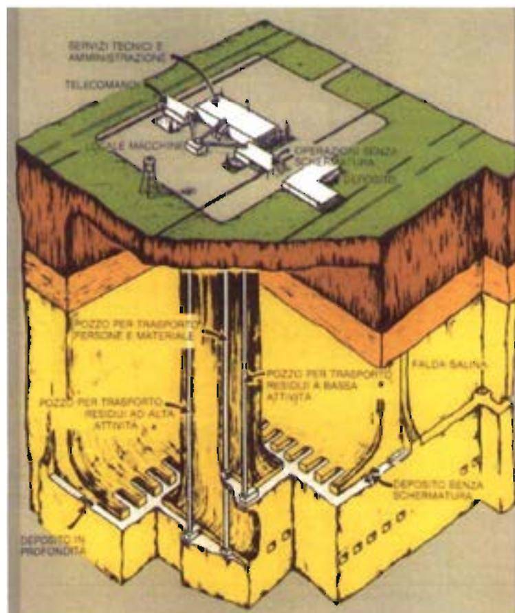
Fig. 1.38 – Schema di deposito geologico
