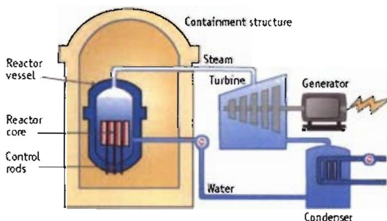
**Fig. 1.5 – Schema di Reattore ad Acqua Bollente (BWR)**
