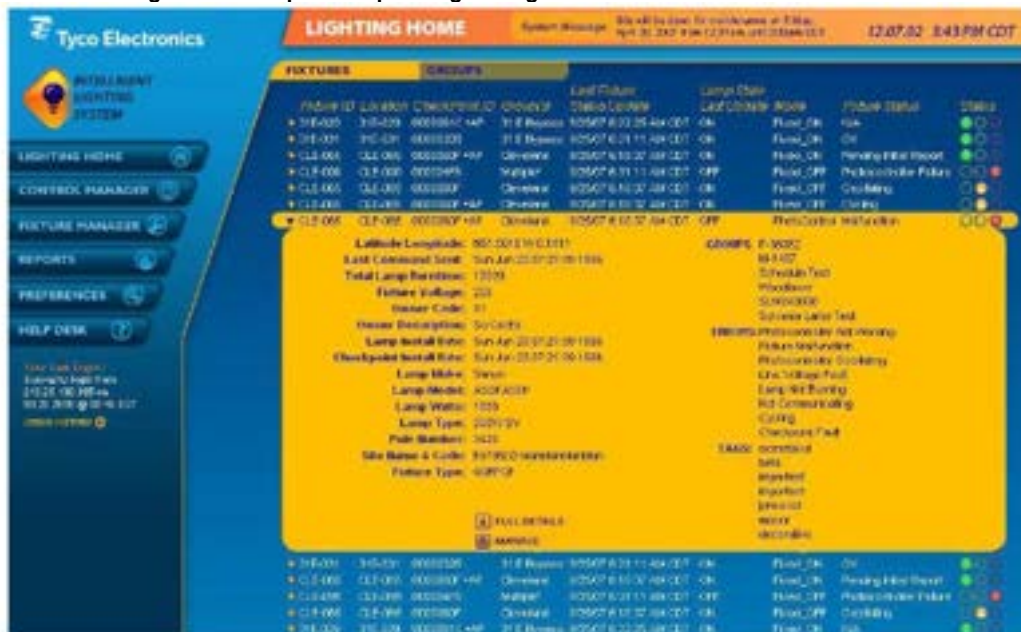
Figura 82 Homepage del sistema di controllo e gestione che mostra le capacità di monitoraggio degli apparecchi, attraverso la visualizzazione del loro stato e delle proprietà TYCO
