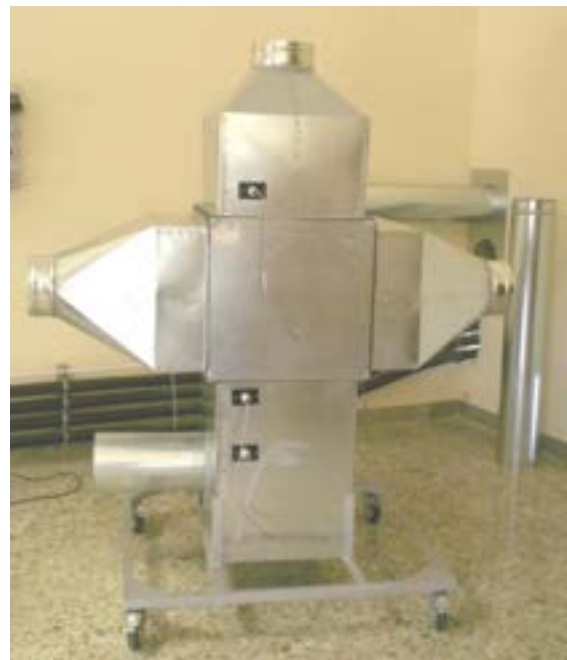
Figura 25: Cellula di test per scambiatori di calore aria-aria a pacco con umidificazione continua del flusso d'aria secondario
