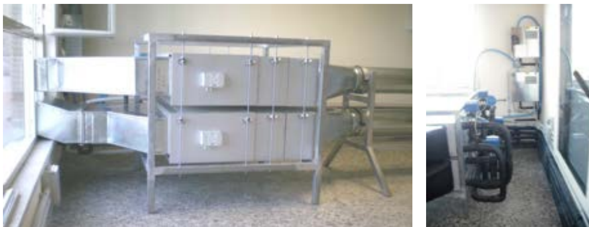
Figura 21: Foto delle due Unità di Trattamento dell'Aria da utilizzare per ottenere prefissate condizioni di umidità, temperatura e portata nei due flussi d'aria da inviare alla cellula di test
