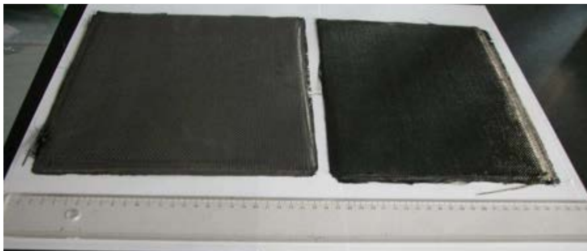
Fig. 19 – Pannelli in C/C ed in SiC ottenuti per CVI+PIP
