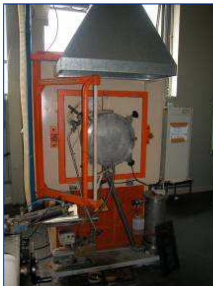
Fig. 16 – Forno ITEM della FN per trattamenti di PIP
