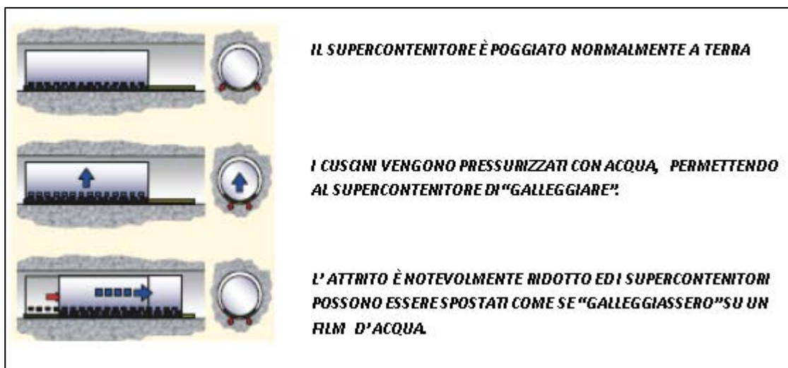
Fig. 3.12b: Sistema per lo spostamento dei supercontenitori.
