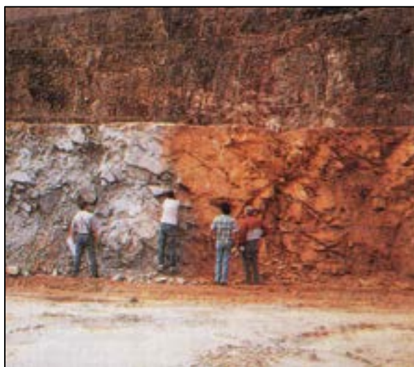
Fig. 6.10 Fronte redox esposto nel fronte di escavazione nella miniera di uranio di Osamu Utsumi (Brasile)
