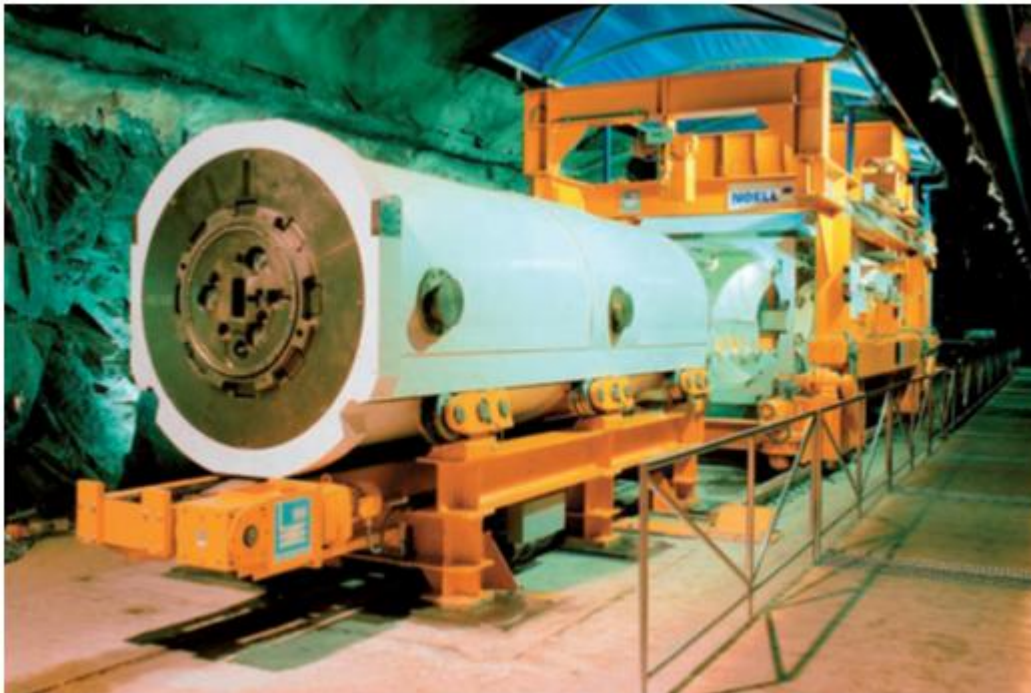
Fig. 3.12a: Prototipo di macchina per la deposizione dei rifiuti negli appositi fori.
