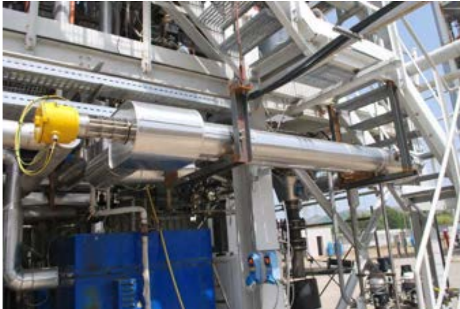
Figura 2.2. Sistema di riscaldamento degli agenti gassificanti.
