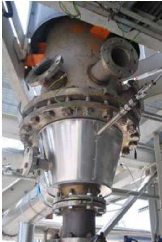
Figura 2.1. La parte inferiore del gassificatore pilota.
