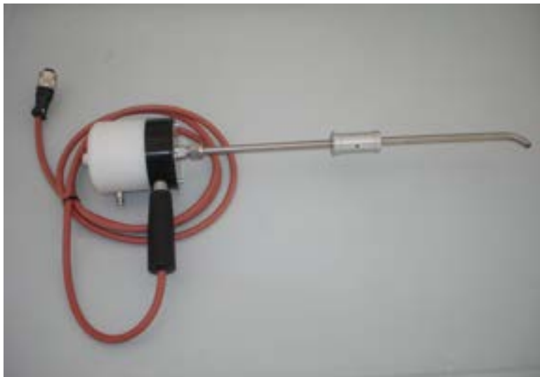
Fig. 2 – Sonda portatile per il campionamento del syngas
