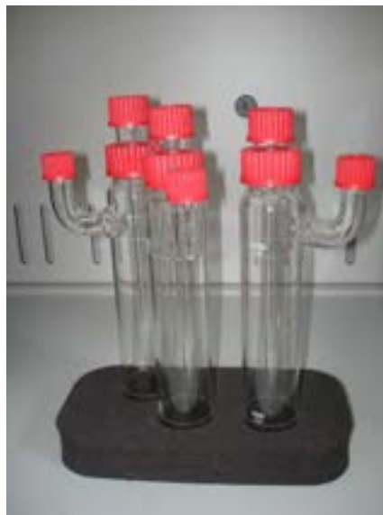
Fig. 4 - Sistema di gorgogliatori per la separazione dell'umidità e del TAR dal gas di sintesi
