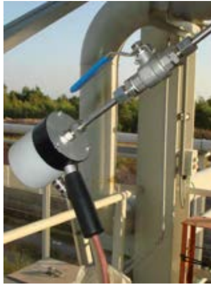
Fig. 3 – Sonda con filtro riscaldato per il campionamento del syngas
