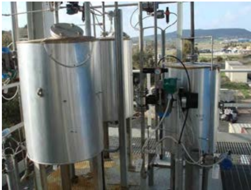
Figura 2.5. Sistema di desolforazione a caldo del syngas.
