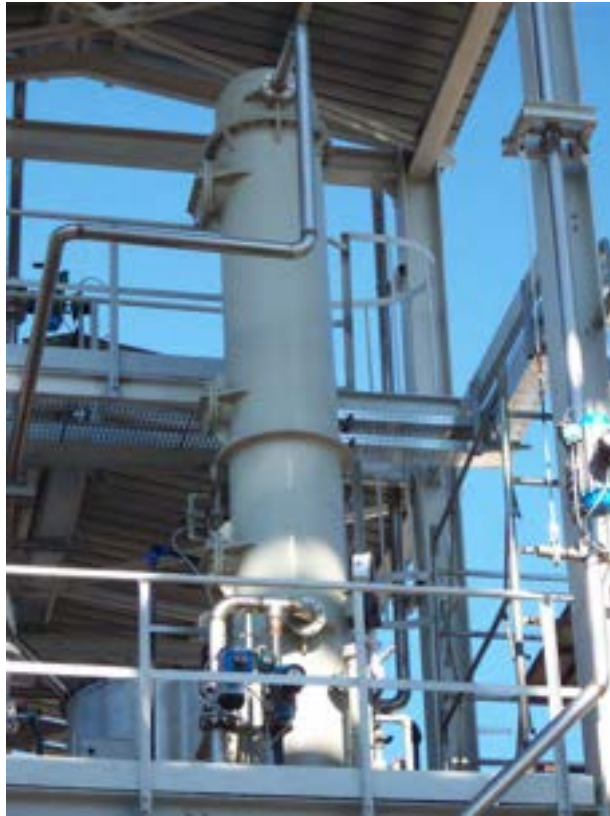
Figura 2.3. Colonna di desolforazione a freddo del syngas.
