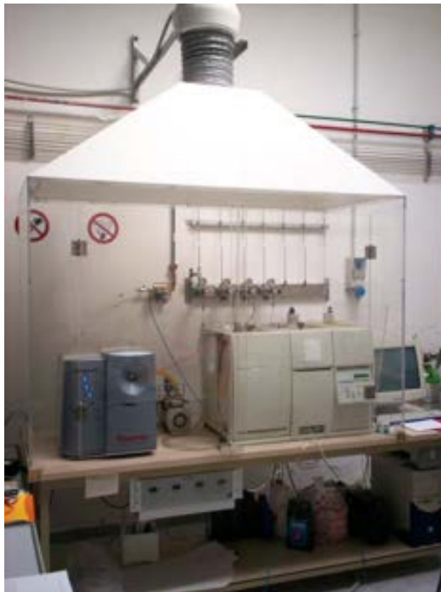
Figura 2. Apparato da laboratorio per le misure di adsorbimento di H 2 S
