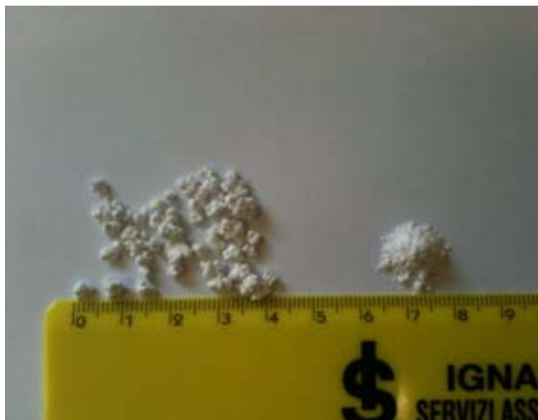
Figura 5. Aspetto macroscopico del composito TS_30_T500 sotto forma di pellet (a sinistra) e in polvere (a destra)
