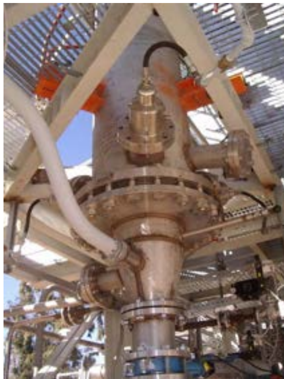
Figura 6.1. La parte inferiore del gassificatore pilota Sotacarbo.
